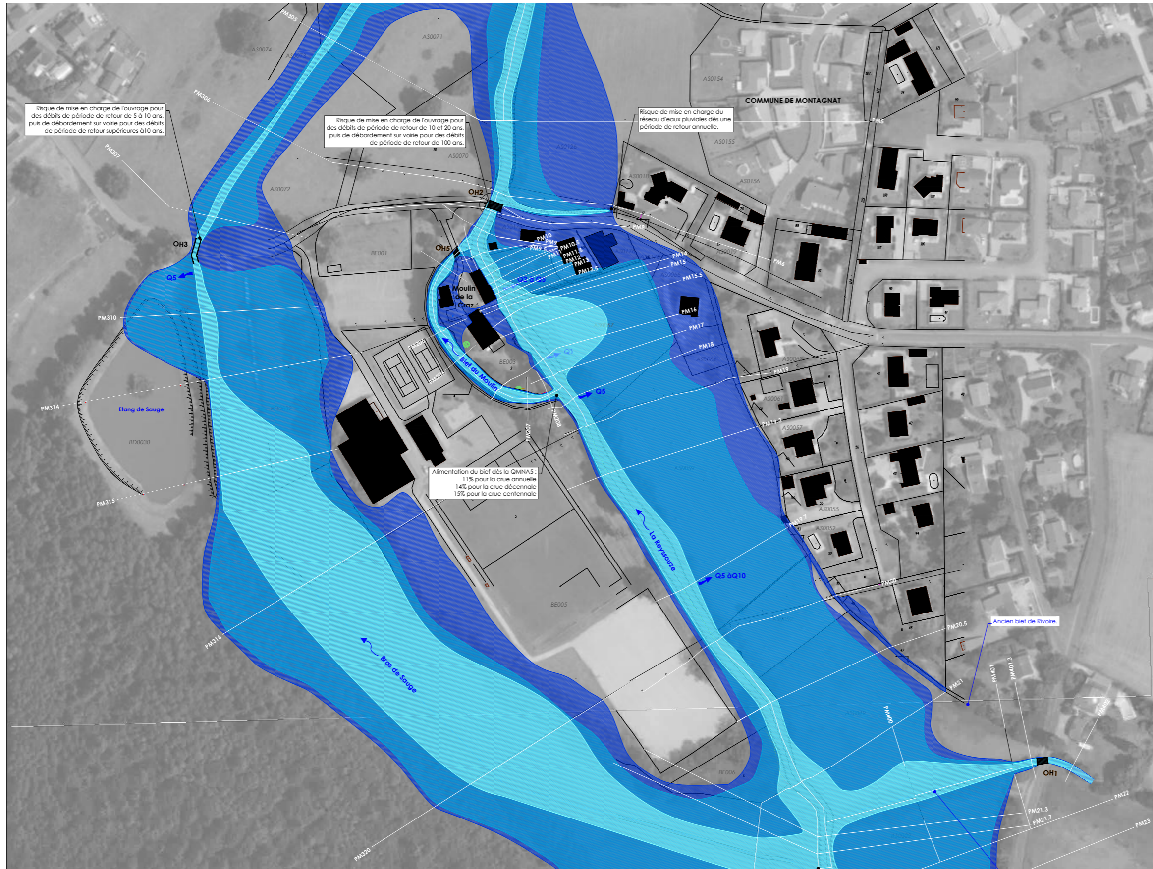
Figure 37 Plan des zones inondables de la Reyssouze obtenues après modélisation de l'état projeté. Source : Biotec, 2023.
