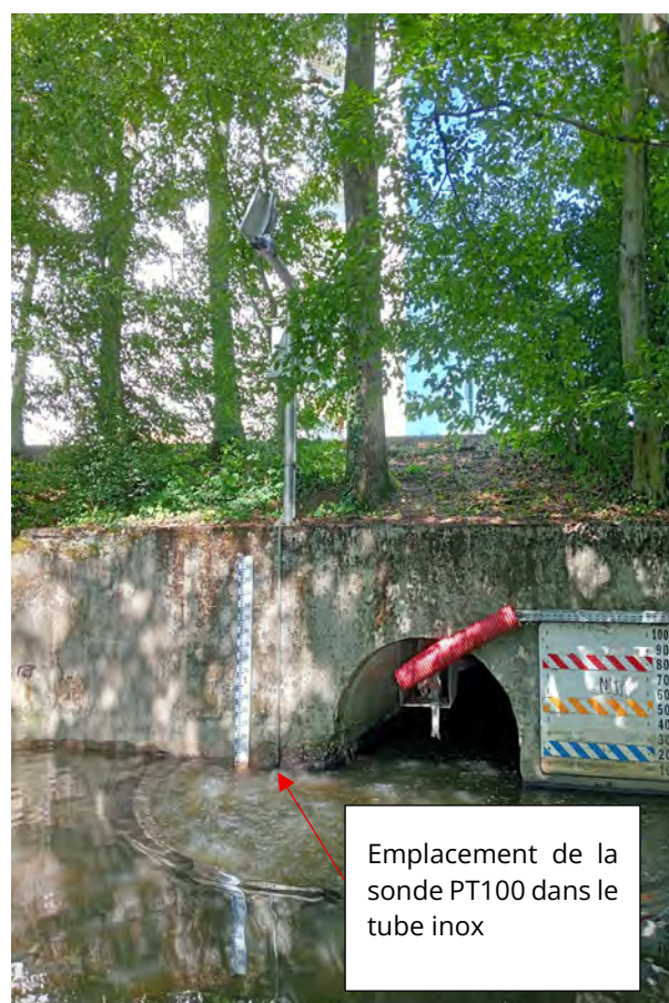
(Gauche) Station de mesure Paratronic LNS connectée à un ordinateur pour le paramétrage. (Droite) Localisation de la sonde de température in-situ.
