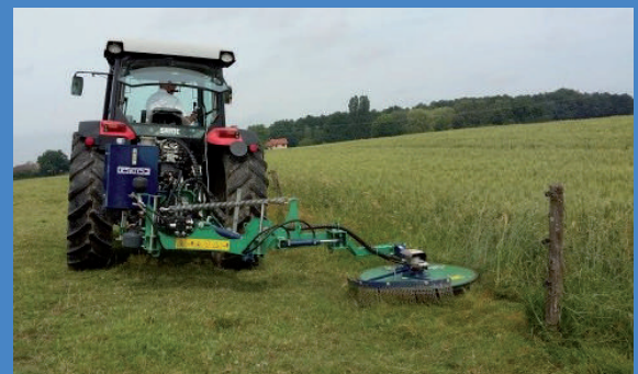
Démonstration d'entretien sous clôture avec le matériel des établissements ARBAN (Jayat)
